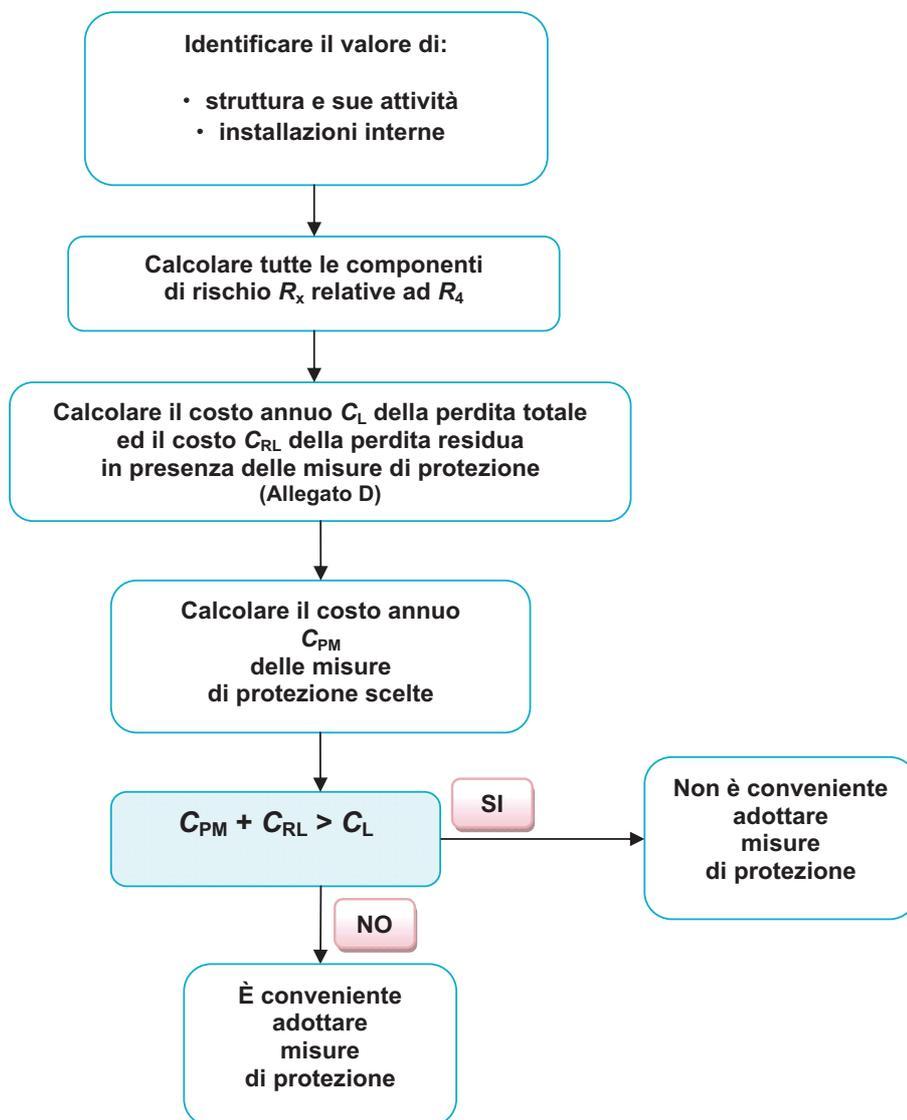
Figura 2 - Procedura per valutare la convenienza economica delle misure di protezione
