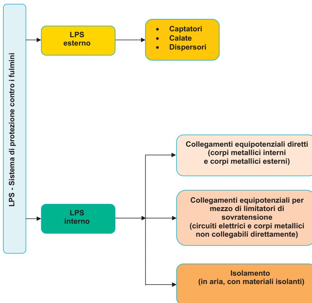
Schematizzazione di un sistema di protezione contro i fulmini (LPS)
