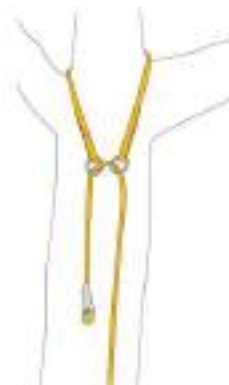
Fig. 8 - Ancoraggio passante per corda raddoppiata
