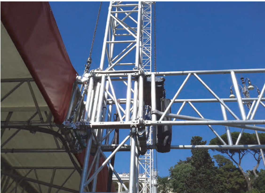
Figura 1.4 – 12 Esempio di elemento di movimentazione: paranco elettrico a catena
