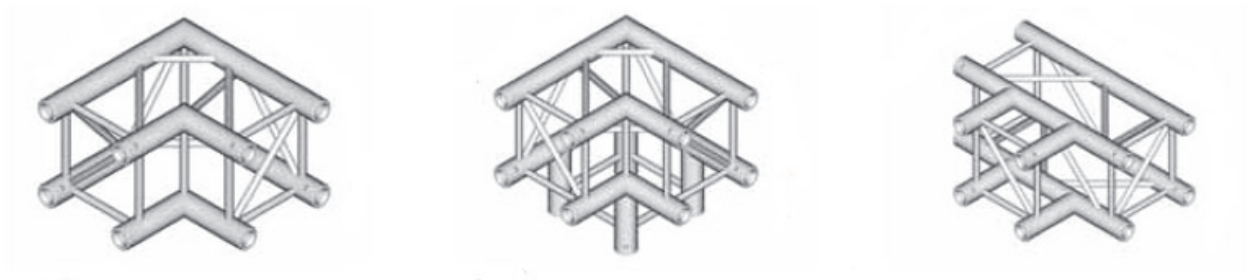
Figura 1.4 – 5 Sistema di giunzione ad angolo di 90° a due vie, tre vie e tre vie a T
