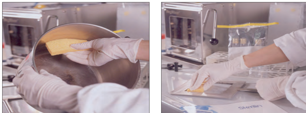
Figura 7 - Campionamento con la metodica sponge-bag
